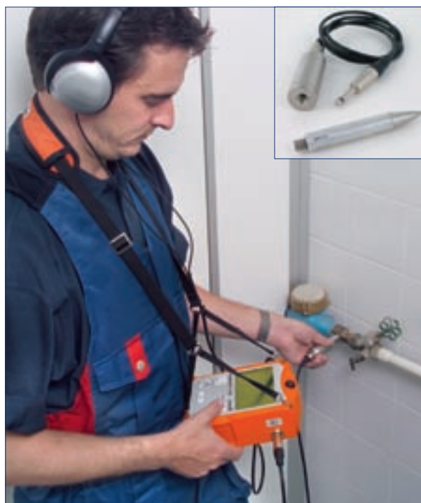
Поиск утечек в помещениях в труднодоступных местах может осуществляться при помощи микрофона ЕМ 30 с коротким щупом.
